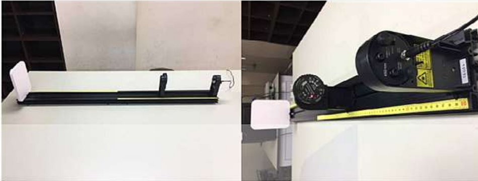
그림 5 단일 슬릿 회절 실험 장치
